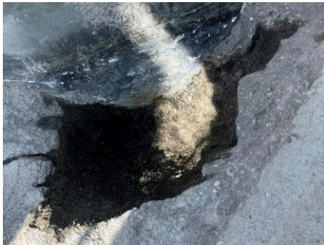
Abbildung 35: Dunkle Färbung über gesamte Tiefe der Freilegung Mast 4A
