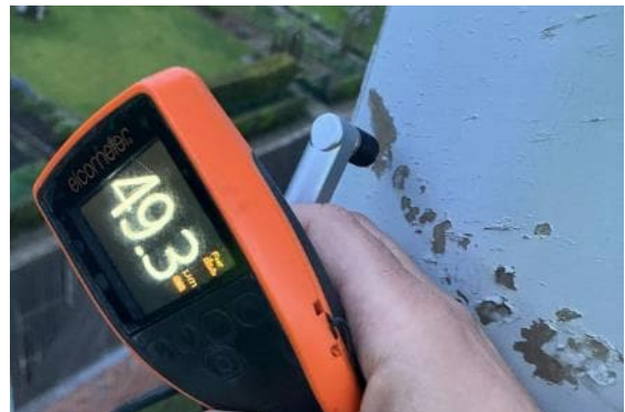
Abbildung 67: Verringerte Schichtdicken im Bereich der Abplatzungen an der Beschichtung
