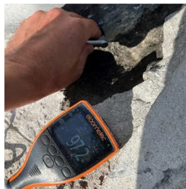
Abbildung 38: Schichtdickenmessung im Bereich der Dunkelfärbung (97,2 µm) Mast 4A
