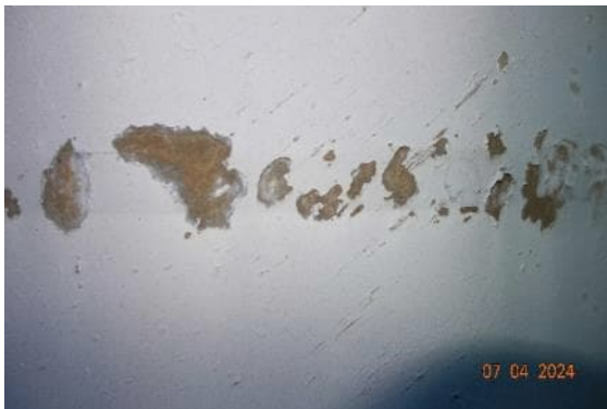
Abbildung 66: Abplatzungen der Beschichtung mit Korrosionsspuren im Bereich ehemals angebrachter Blehbänder o.Ä.
