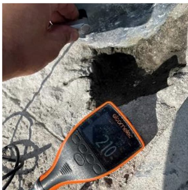
Abbildung 37: Schichtdickenmessung oberhalb der Dunkelfärbung (210 µm) Mast 4A
